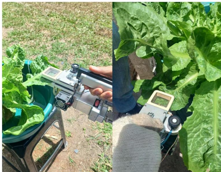
**Figura 9.** Avaliação das trocas gasosas nas folhas a partir do Analisador de gás infravermelho portátil.
