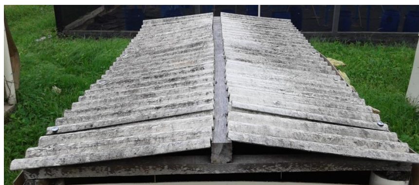
Figura 4. Telhado de fibrocimento do modelo em escala reduzida.
