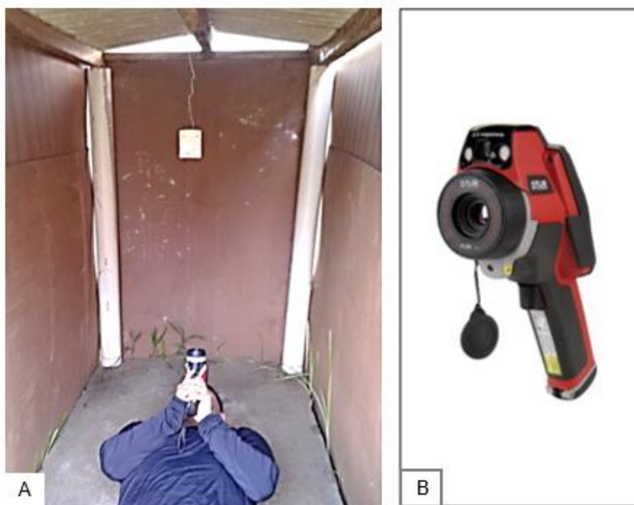
Figura 10. Registro das imagens termográficas no interior do modelo reduzido (A); Câmera termográfica (B).
