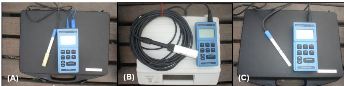
Figura 06. Equipamentos portáteis utilizados nas coletas em campo: pH-metro (A), oxímetro (B), condutivímetro (C).
