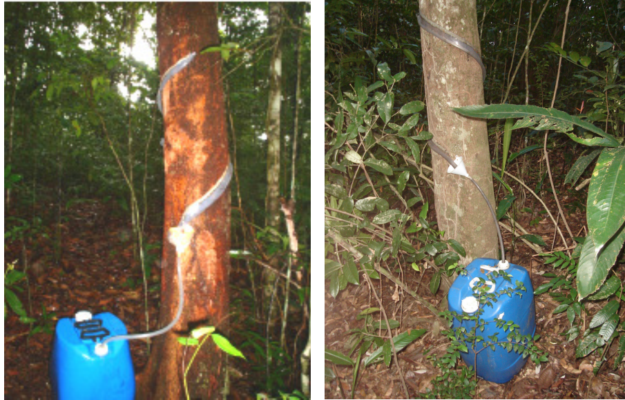
Figura 09. Sistema coletor de água escoada pelo tronco das árvores do estrato superior
