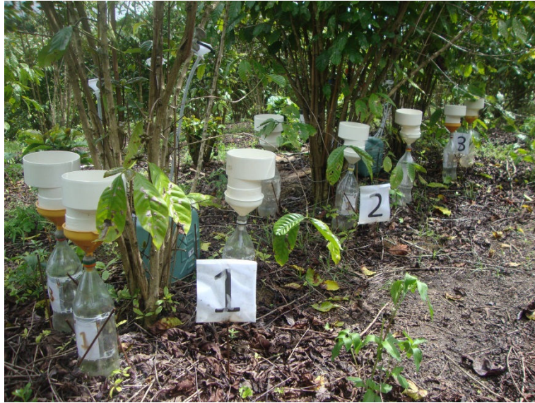
Figura 6. Interceptômetros utilizados para quantificação da precipitação interna na cultura do café
