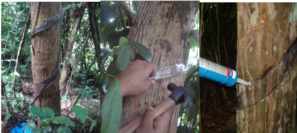
Figura 13. Sistema para coletar escoamento pelo tronco das árvores do estrato superior.
