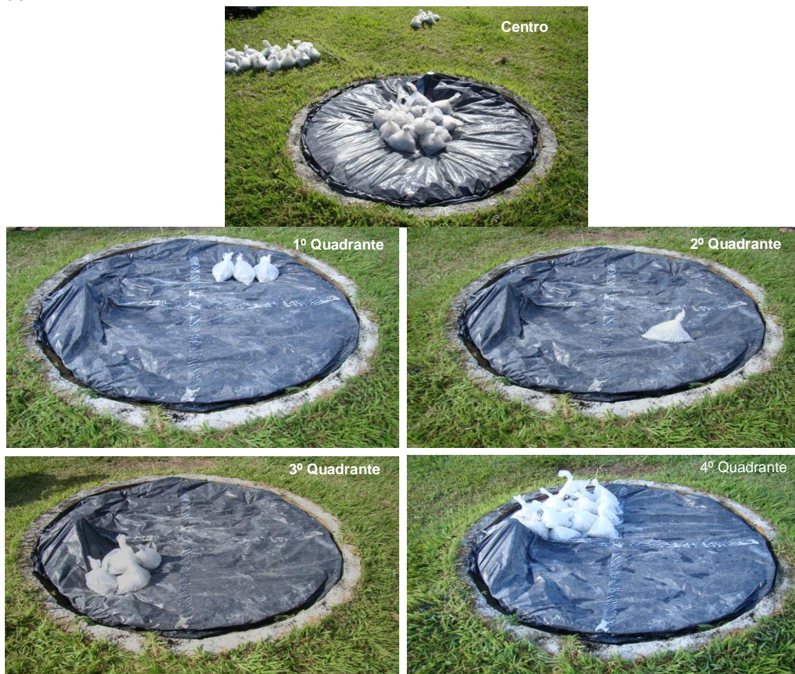
Figura 7 - Detalhes da calibração no setor central e nos quadrantes pela adição e retirada de pesos padrão.
