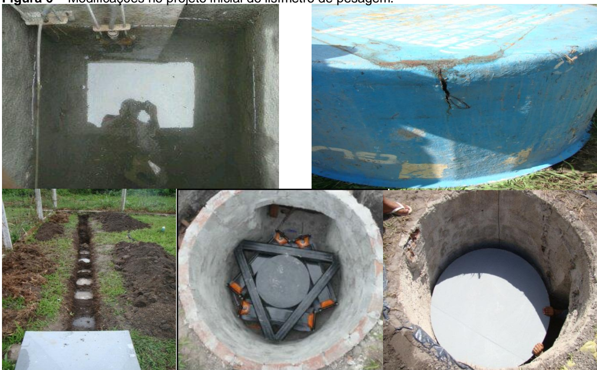
Figura 6 – Modificações no projeto inicial do lisímetro de pesagem.
