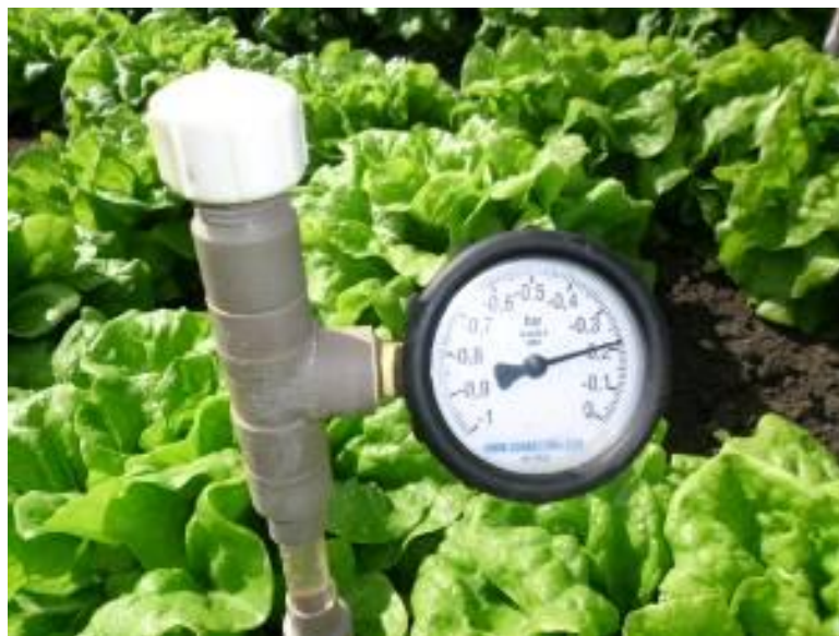
Figura 7. Vista do tensiômetro com vacuômetro da marca SONDATERRA, usado na determinação direta do potencial mátrico do solo em (kpa)
