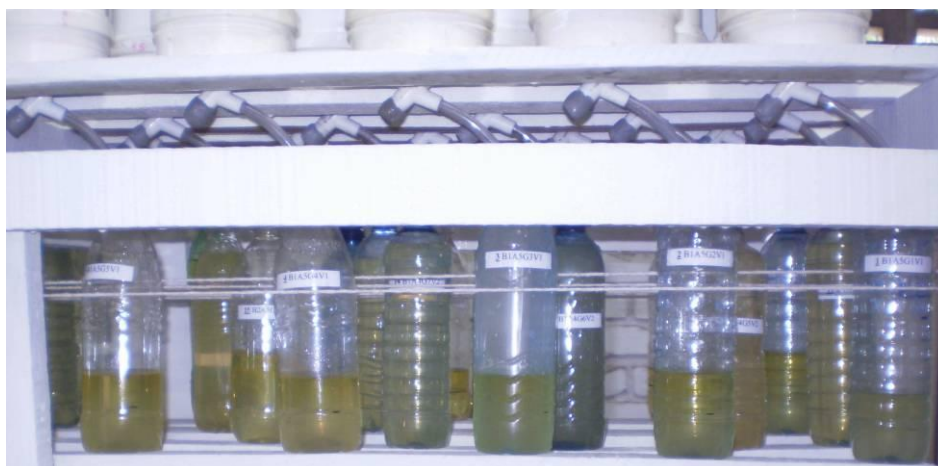
Figura 05. Vista da coleta da solução drenada para determinação da condutividade hidráulica saturada, condutividade elétrica e sódio
