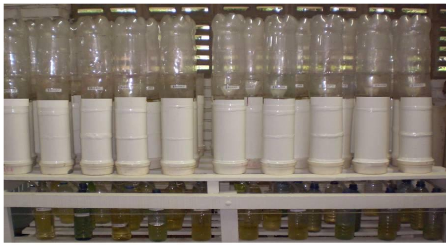
Figura 04. Unidades experimentais utilizadas no estudo da correção da salinidade e sodicidade das amostras de solos coletadas no Perímetro Irrigado de Ibimirim-PE
