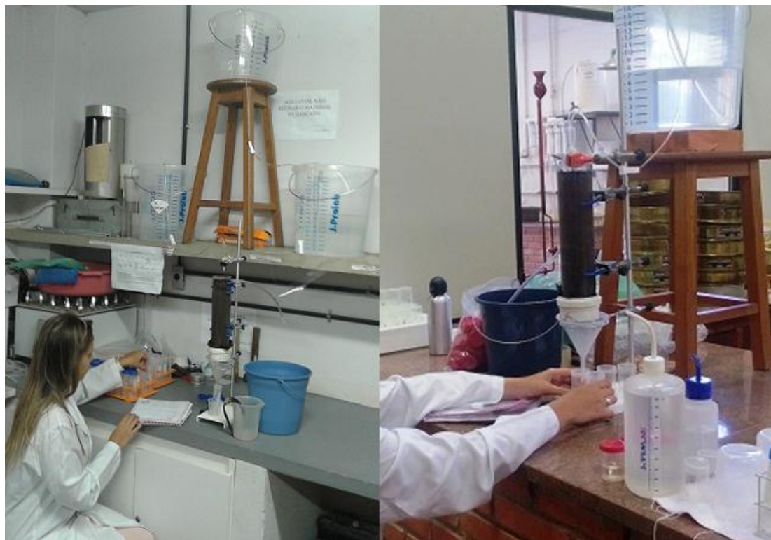
Figura 9. Esquema experimental utilizado para elaboração das Breakthrough Curves: processo de aplicação e coleta
