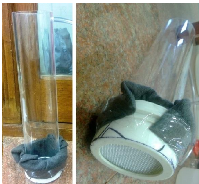
Figura 6. Coluna de acrílico utilizada para a elaboração das curvas de distribuição de efluentes, Breakthrough Curves
