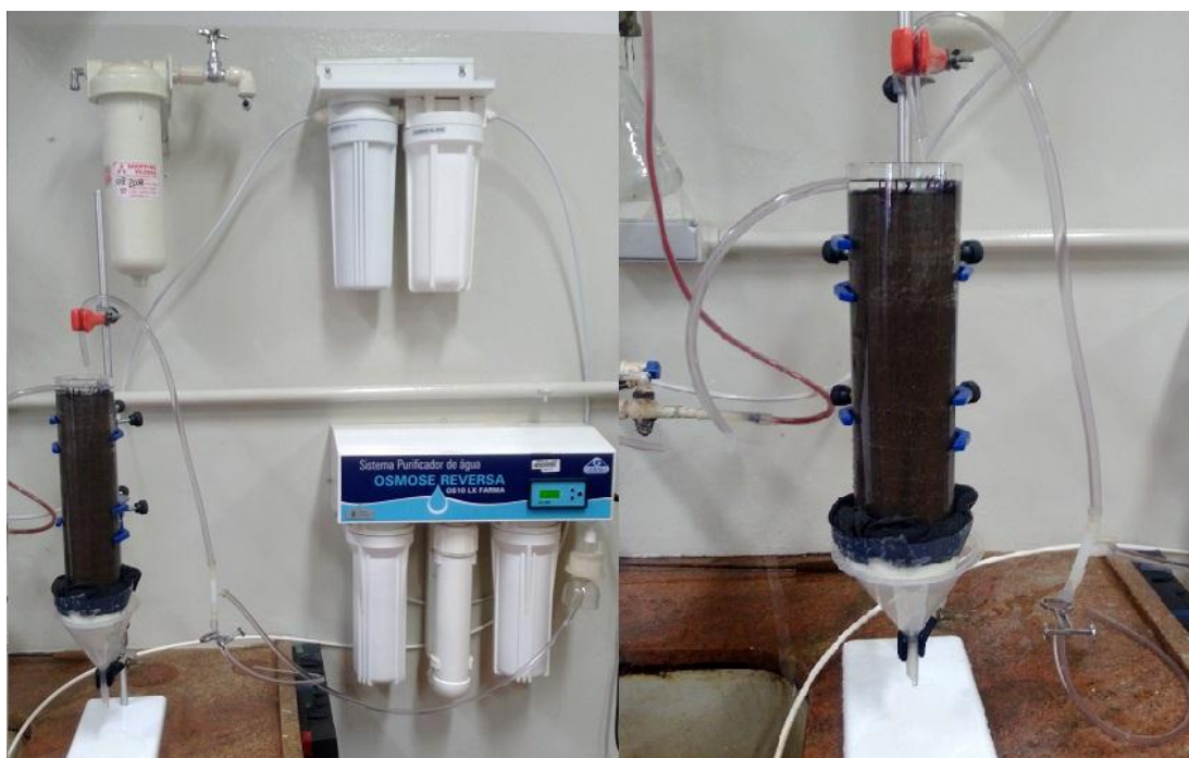
Figura 8. Esquema experimental utilizado para elaboração das Breakthrough Curves: processo de lixiviação
