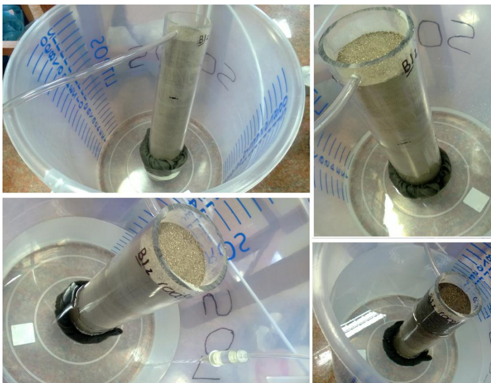
Figura 7. Esquema experimental utilizado para elaboração das Breakthrough Curves: processo de saturação
