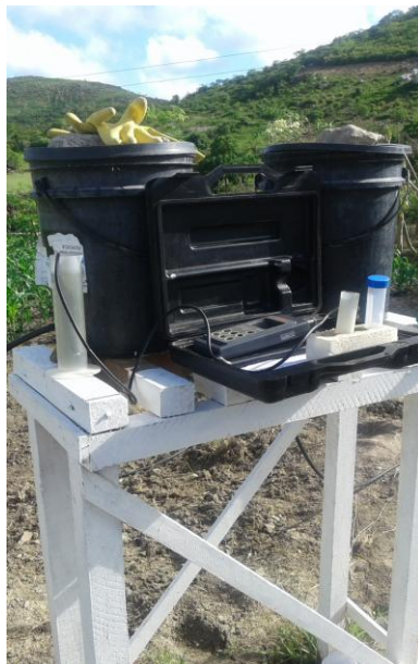
Figura 22 - Monitoramento das condutividades elétricas do efluente tratado e da água de abastecimento local.
