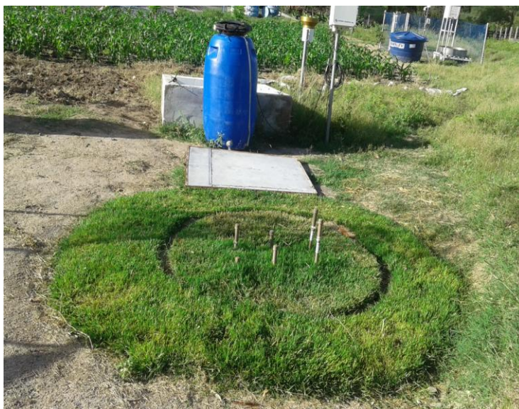
Figura 9 – Lisímetro de lençol freático de carga constante para quantificação da ETo padrão-grama, com reservatório de alimentação.
