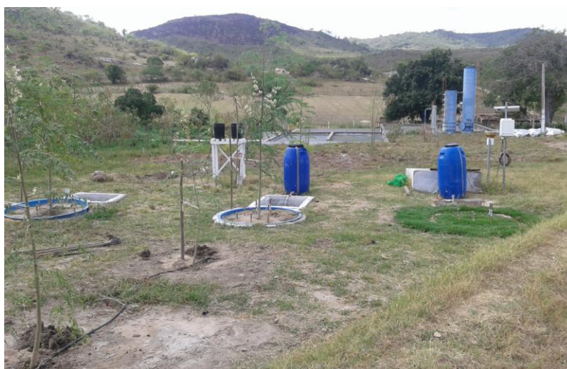
Figura 20 – Vista parcial das cápsulas extratoras instaladas nos respectivos lisímetros.
