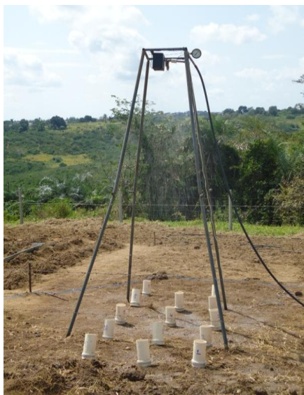
Figura 5. Calibração do simulador de chuva para área da parcela experimental.
