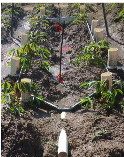
Figura 7. Distância entre dois pontos para percorrer o corante em parcela experimental
