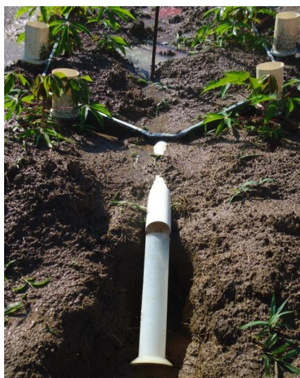
Figura 8. Coleta da enxurrada com auxílio de proveta graduada em parcela experimental.
