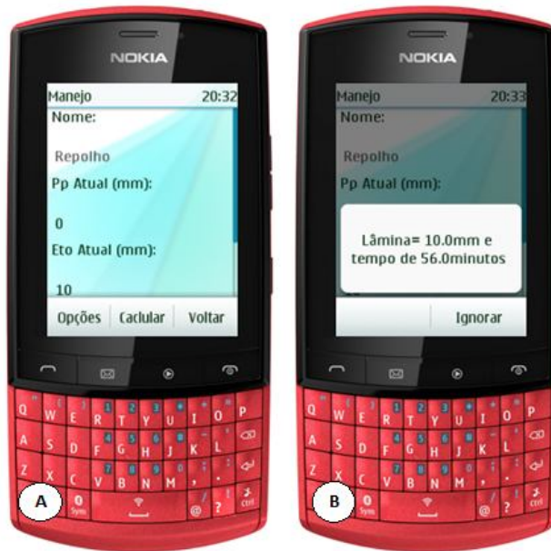
Figura 17. Tela de inserção de dados climáticos (A); Resultado obtido pelo IGmanejo mobile que representa a recomendação para o agricultor (B).
