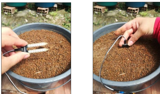
Figura 3. Instalação dos sensores YL-69.
