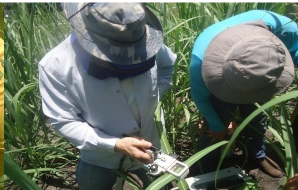
Figura 4. Analisador de fotossíntese modelo LI-6400 (Licor, Lincoln NE, USA) (A), monitoramento das trocas gasosas em campo (B), (C) e (D). Fonte: Elaborado pelo autor.
