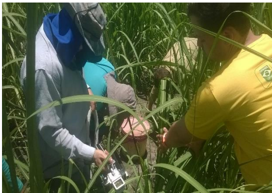
Figura 4. Analisador de fotossíntese modelo LI-6400 (Licor, Lincoln NE, USA) (A), monitoramento das trocas gasosas em campo (B), (C) e (D). Fonte: Elaborado pelo autor.
