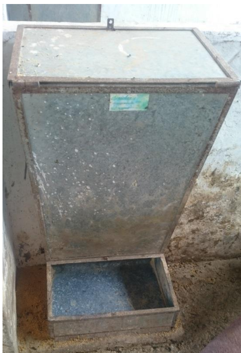
Figura 5. Comedouro semiautomático em chapa metálica galvanizada
