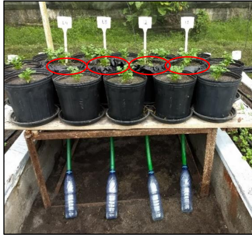
Figura 5. Estrutura dos lisímetros de drenagem instalados no interior da casa de vegetação, Recife, 2018.
