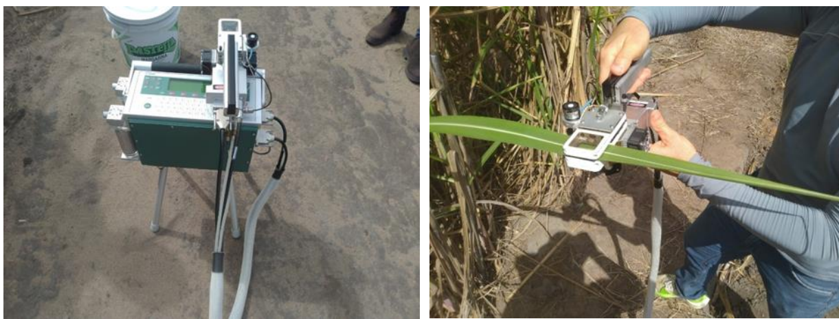
Figura 7. Analisador Portátil de Gás Infravermelho (Infla-Red Gas Analyzer–IRGA) modelo: LI 6400 XT (LI COR) utilizado para a quantificação das trocas gasosas das plantas.
