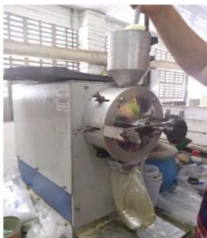
Figura 6: Processamento das amostras (colmos e ponteiro + folhas) da cana-de-açúcar em moinho tipo Willey
