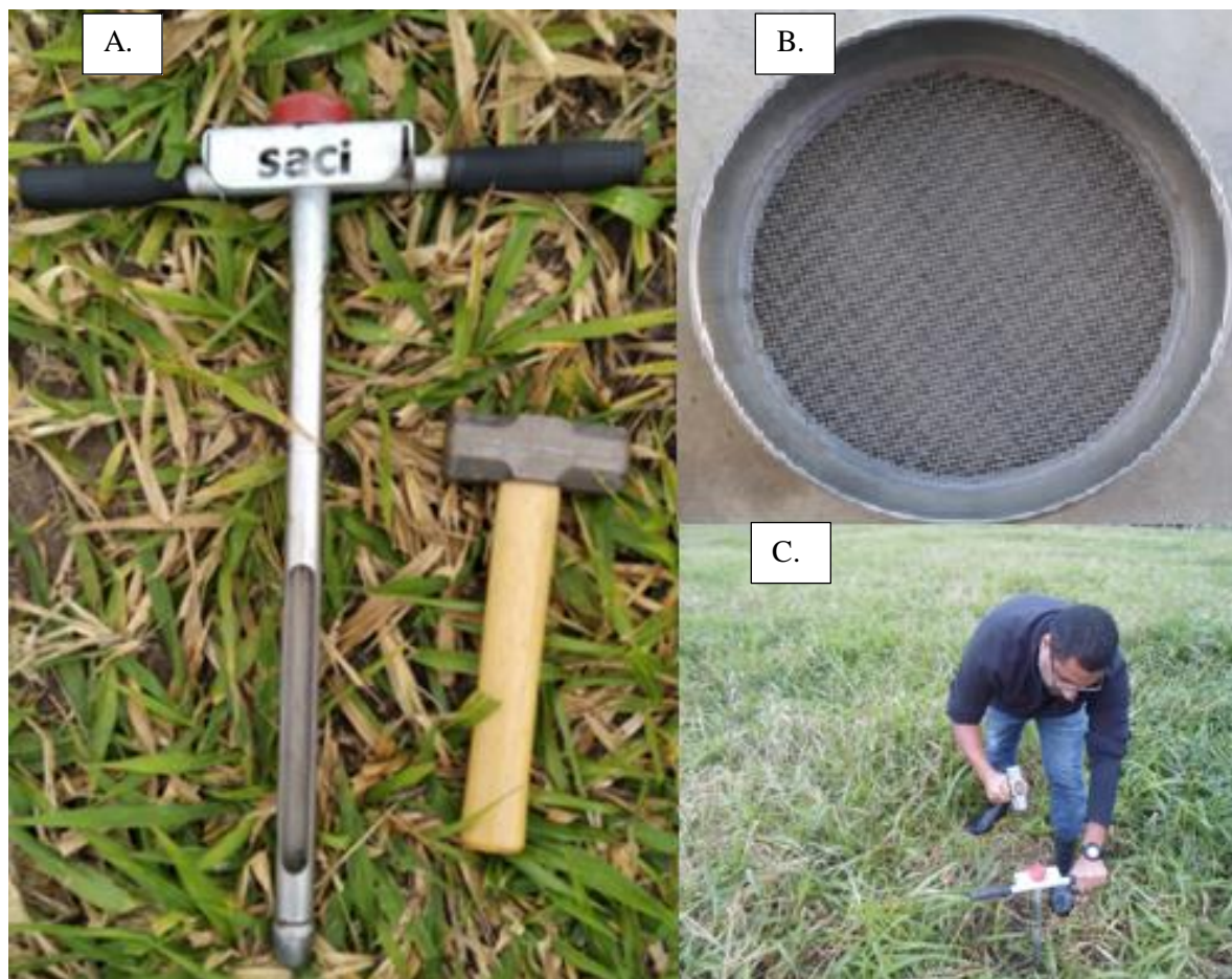
Figura 4. Sonda de percussão para coleta de amostra de raiz (A); peneira de 2,00 mm para remoção do solo (B); coleta em campo da amostra de raiz (C).
