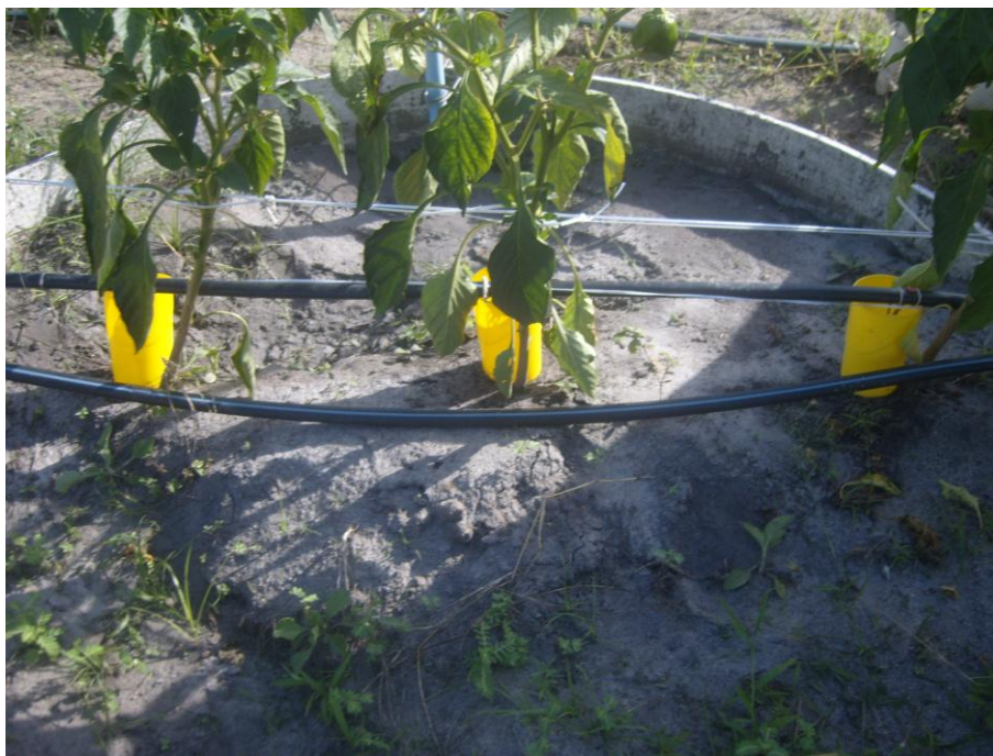
Figura 1. Coleta dos volumes de água para determinação da vazão dos emissores e da uniformidade de aplicação, aos 120 dias após a implantação da cultura
