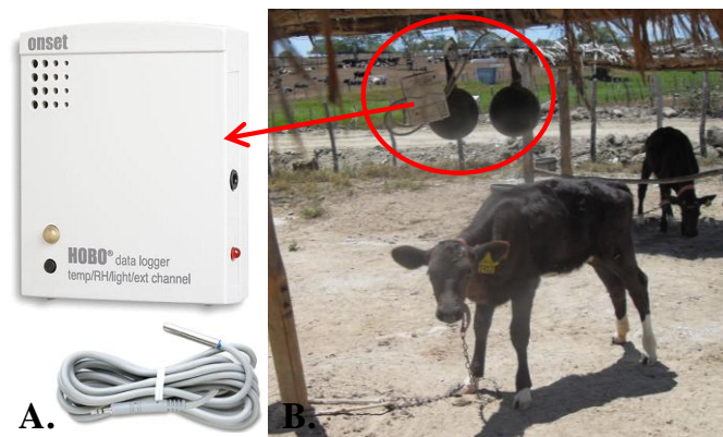
Figura 2. Datalogger utilizado para registro das variáveis ambientais (A); registradores instalados no interior do abrigo individual (B)
