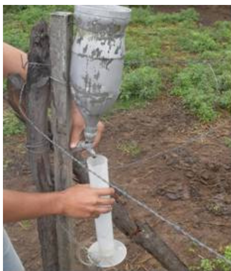
Figura 4 – Detalhe do pluviômetro alternativo (UFRPE).
