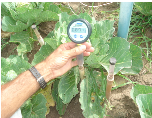
Figura 4 – Vista do Tensiômetro e do Tensímetro de Punção no campo
