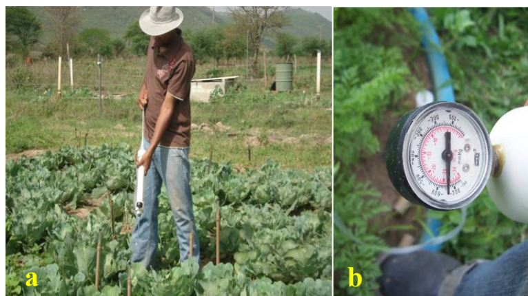
Figura 5.a 5.b – Sucção da solução do solo com a bomba a vácuo manual
