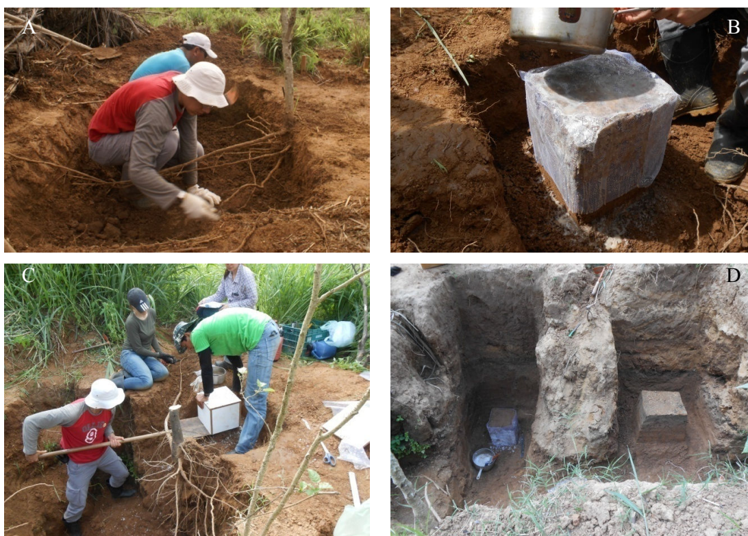
Figura 8. Coleta das amostras indeformadas de solo no sítio experimental. A Escavação da trincheira, B aplicação de parafina no bloco de solo, C remoção da 1ª caixa com solo e D aspecto da trincheira antes da coleta das últimas caixas.
