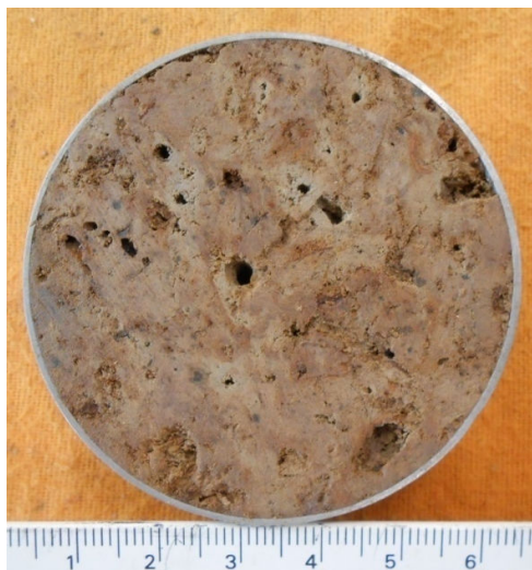
Figura 12. Corpo de prova da profundidade 0,75 a 1,0 m apresentando elevado índice de vazios.
