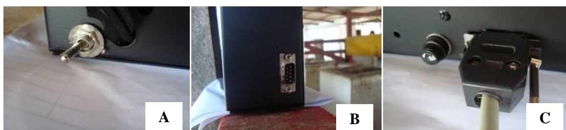
Figura 3 – Chave liga/desliga (A), entrada (DB 9) para programação (B) e comunicação (DB 15) com os sensores(C).
