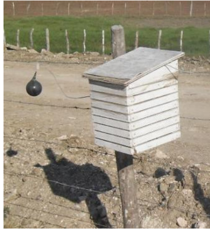
Figura 4. Abrigo meteorológico utilizado para o registro das variáveis ambientais externas.
