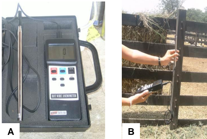
Figura 10. Termoanemômetro digital, modelo TAFR-180 (A) utilizado para a determinação da velocidade do vento (Vv) (B).
