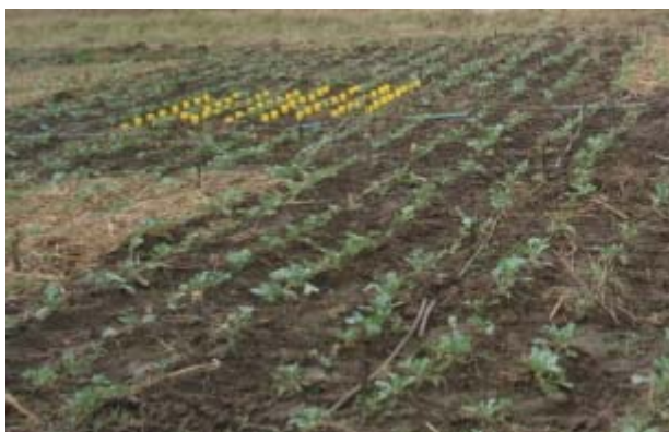
FIGURA 1 Quadra com coletores pluviométricos para determinação da lâmina média de irrigação precipitada.
