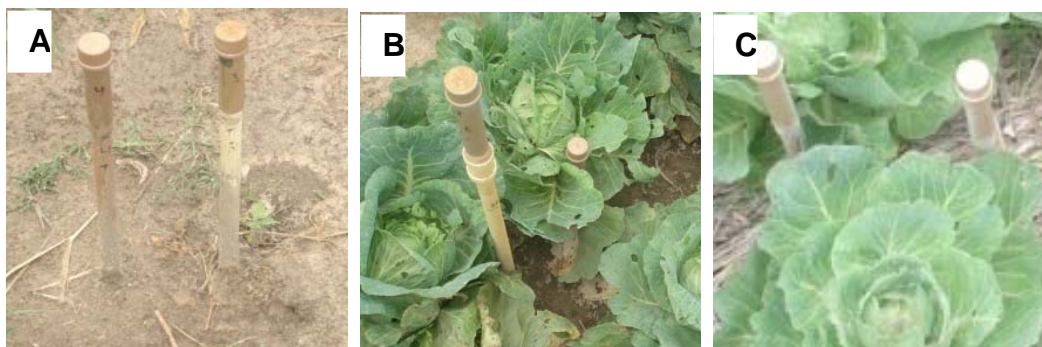
FIGURA 3. Visão geral de tensiômetros instalados em: A) solo descoberto, B) solo com repolho e C) solo com repolho e cobertura morta.
