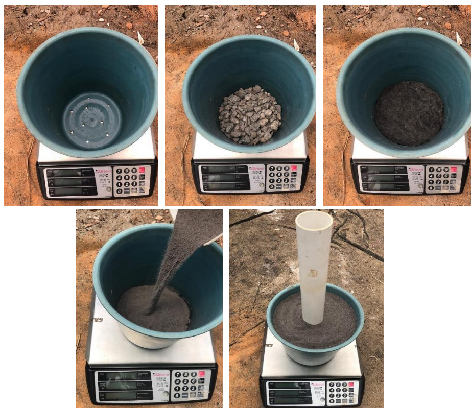
Figura 3. Sequência fotográfica da montagem do conjunto vaso, brita, bidim, solo e tubo de acesso.
