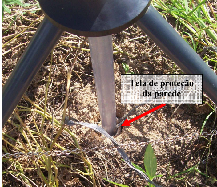
Figura 7. Detalhe do furo encamisado com uma tela de proteção das paredes laterais durante a realização de um teste.
