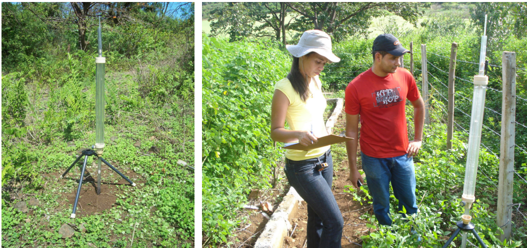
Figura 10. Avaliação da infiltrabilidade e da condutividade hidráulica na Bacia Experimental do Xaréu por meio do Permeômetro de Guelph.
