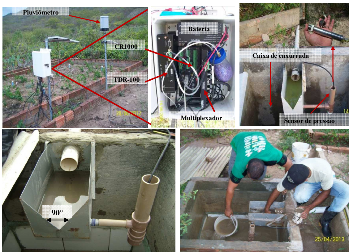
Figura 6. Vista parcial do sistema de coleta de dados, vertedor para medição de vazão e caixa de coleta de enxurrada após um evento erosivo em março de 2012
