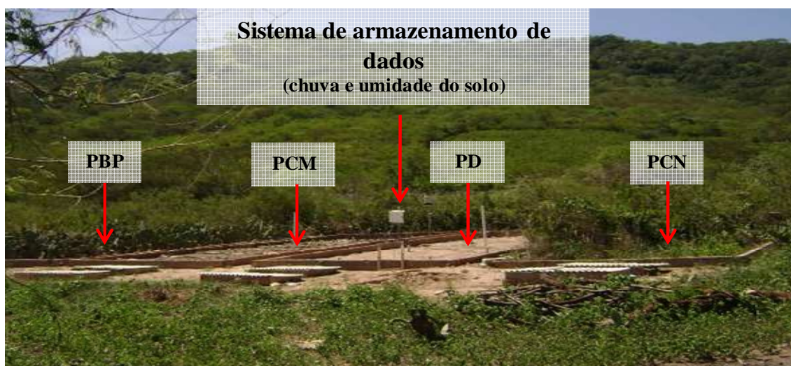
Figura 4. Vista parcial das diferentes condições de coberturas das parcelas de erosão
