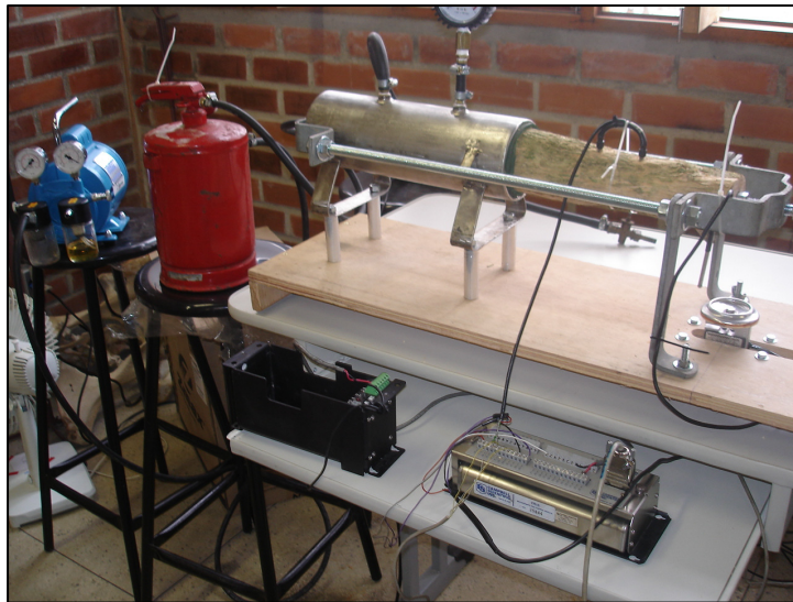
Figura 10 - Câmara de calibração de fluxo de seiva
