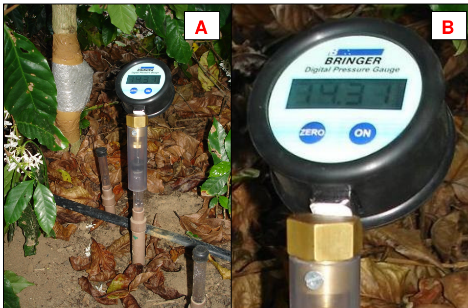
Figura 1 - Estação tensiométrica composta por tensiômetros de punção (A) e leitura realizada por tensímetro digital (B)
