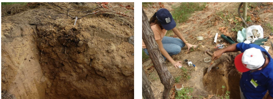
Figura 3.5 - Coleta de amostras de solo para caracterização físico-hídrica do solo da área experimental. Fazenda Agrobrás, Casa Nova – BA.
