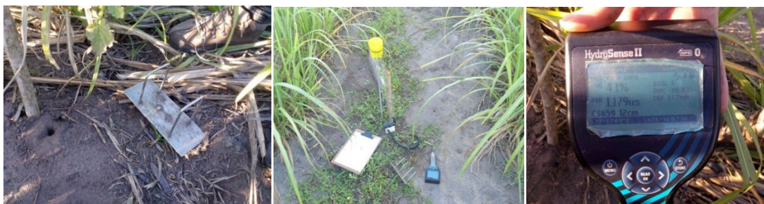
Figura 7. Aferição da umidade do solo antes e após a irrigação. Carpina-PE, 2014.
