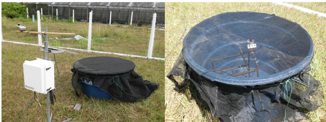
Figura 5. Realização do teste de determinação da porcentagem de sombreamento real das telas
