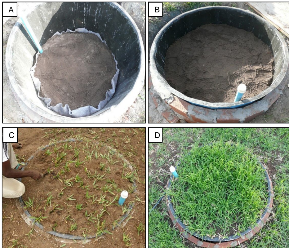
Figura 3.3. Fases de preenchimento do lisímetro com solo em ordem de retirada (A e B) e plantio e desenvolvimento da grama Batatais (C e D).
