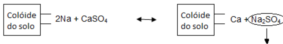
Figura 2: Reação de troca entre os íons \text{Ca}^{2+} presente no gesso e o sódio presente no complexo de troca (Ribeiro et al., 2009)
