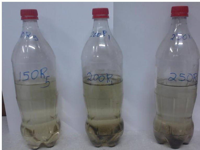
Figura 17- Lixiviados com colóides, a partir do nível 150% da necessidade de gesso.
