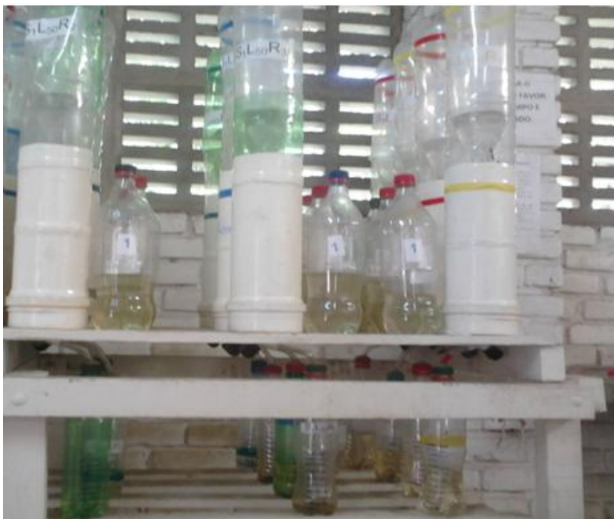
Figura 1- Sistema de aplicação das lâminas de lixiviação e coleta de lixiviado nas colunas de PVC para correção de solo salino-sódico.
