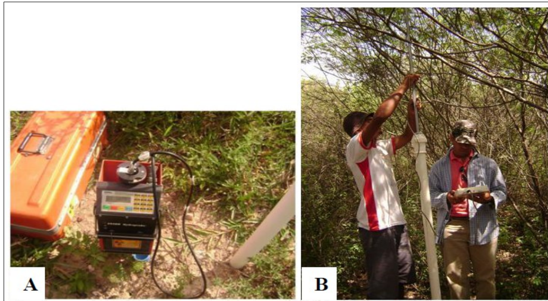
Figura 3. Monitoramento da umidade do solo na bacia hidrográfica do riacho Jatobá utilizando sonda de nêutrons (A) e sonda capacitiva Diviner 2000® (B).
