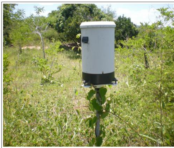
Figura 2. Pluviômetro automático instalado na área da bacia do Jatobá.
