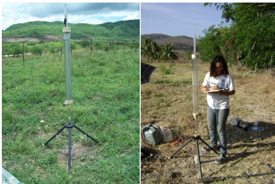
Figura 3.4. Vista do Permeômetro de Guelph instalado no campo
