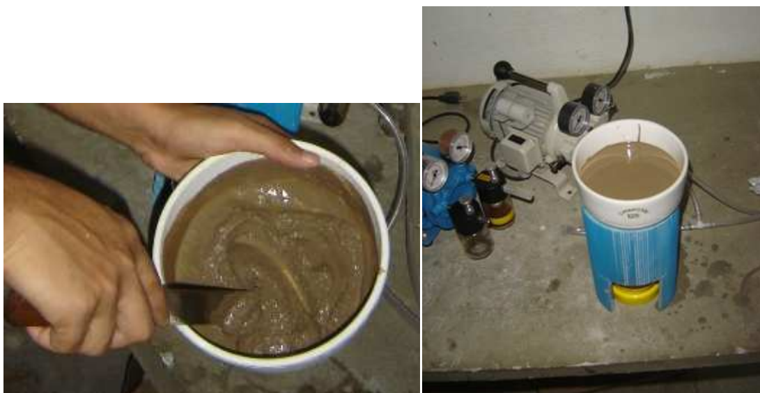
Figura 3.2. Preparo e extração da pasta de saturação do solo
