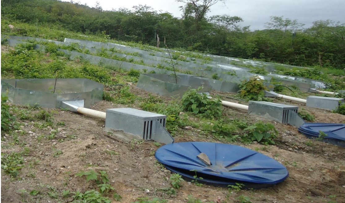
Figura 4. Esboço de instalação das parcelas de erosão estudadas e os respectivos tratamentos: Oleaginosas (T1), Oleaginosas + cobertura morta (T2) e Solo descoberto (T3).
