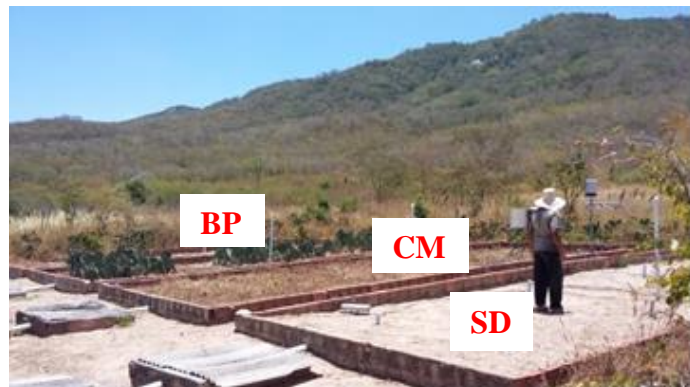
Figura 2. Medição da umidade do solo. Em A: sonda de nêutrons; B: solo descoberto (SD), cobertura morta (CM), barramento em palma (BP); C: cobertura natural (CN).
