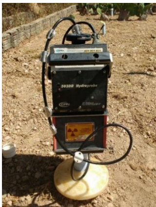
Figura 2. Medição da umidade do solo. Em A: sonda de nêutrons; B: solo descoberto (SD), cobertura morta (CM), barramento em palma (BP); C: cobertura natural (CN).
