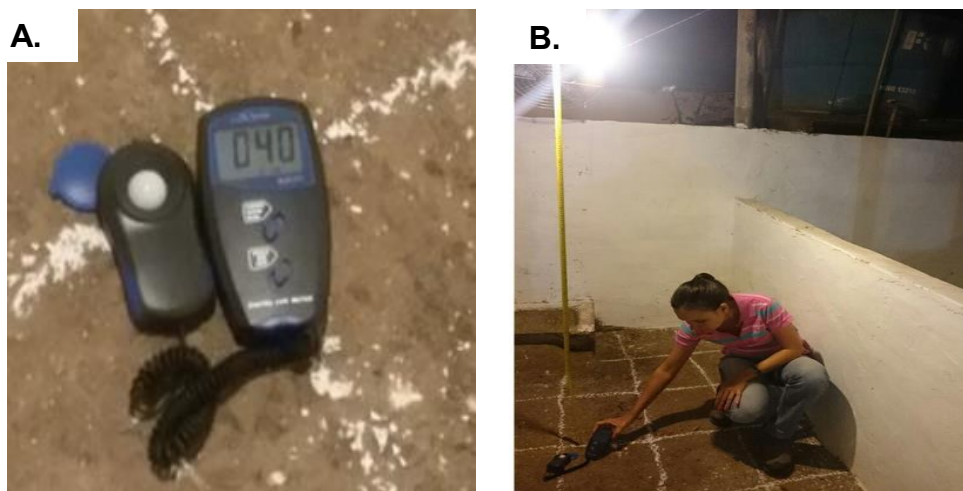
Figura 8. Luxímetro digital (A); verificação da iluminância na baia (B).
