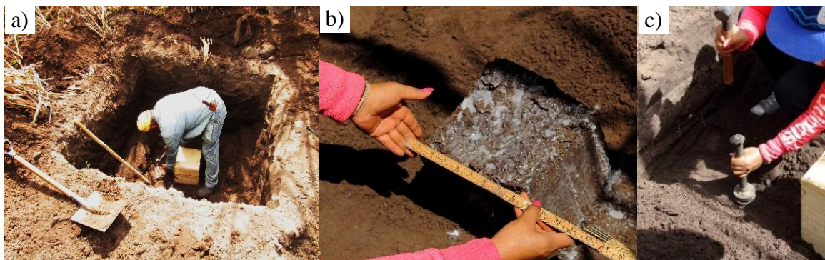
Figura 1. a) Abertura das trincheiras para extração dos blocos indeformados acoplados em caixas, b) Blocos indeformados, c) Amostra indeformada.
