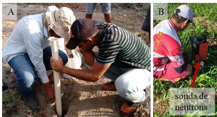
Figura 8. Instalação de piezômetro para monitoramento da água do lençol freático (A) e monitoramento participativo da leitura da umidade do solo na ETE-Mutuca. Fonte: Autor.
