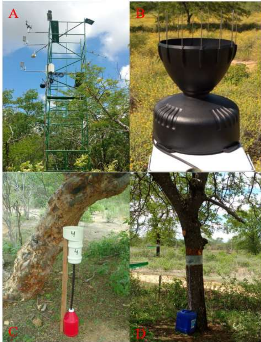
Figura 2. Torre micrometeorológica da Caatinga (A), pluviômetro automático para registrar a precipitação total (B), distribuição dos coletores de precipitação interna (C) e escoamento pelo tronco (D), nas espécies da Caatinga, no município de Floresta, Nordeste Brasileiro.
