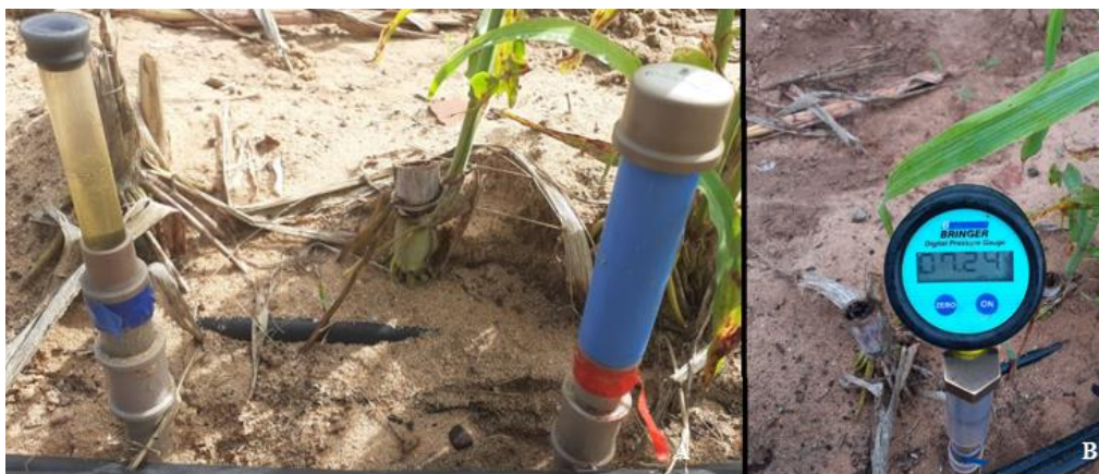
Figura 11. (A) - (B) - Tensiômetros instalados em campo.
