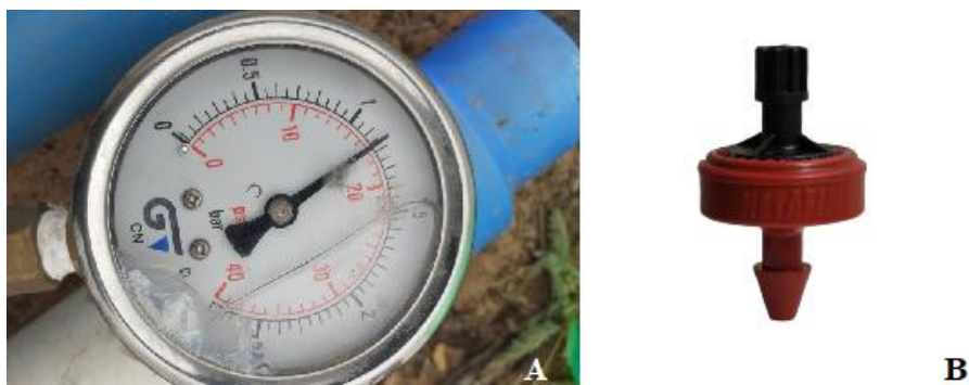
Figura 9. (A) - Pressão do sistema de irrigação; (B) - Gotejador Netafim PCJ
