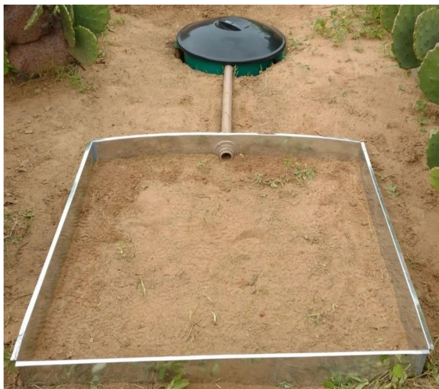
Figura 3. Calha utilizada para captação do volume de água da precipitação escoado.
