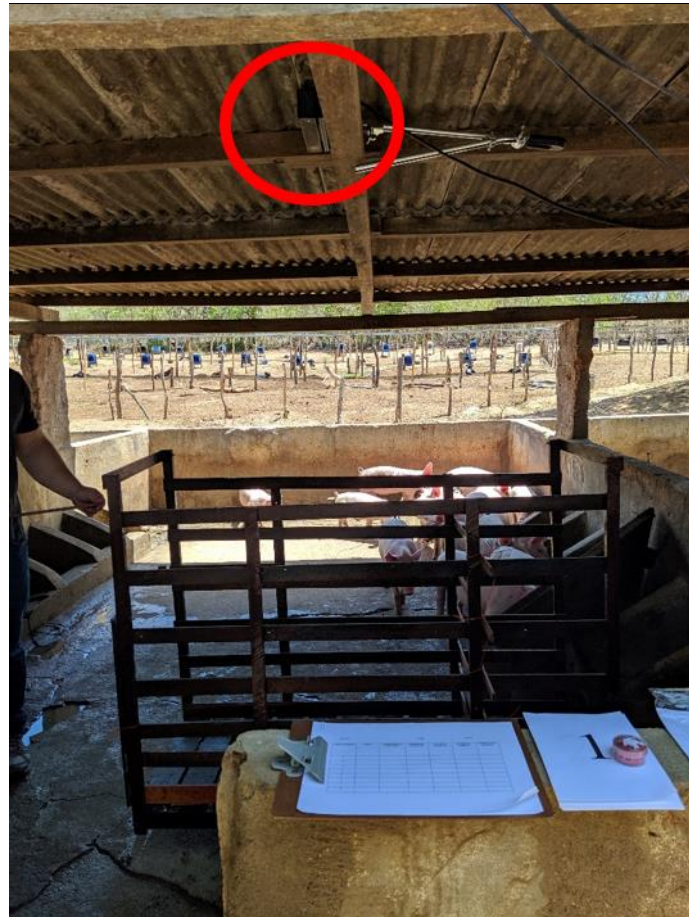
Figura 2 - Imagem da câmera Kinect V2 (círculo vermelho) fixada no telhado da instalação e brete de contenção acoplado à balança
