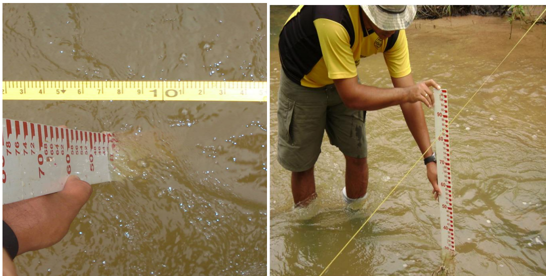
Figura 19. Régua utilizada na determinação da largura da seção e na localização dos pontos de determinação de velocidade e profundidade do escoamento.
