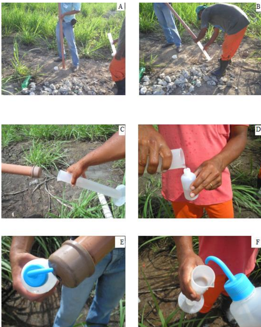
Figura 7. A - Coleta da água do lençol freático, B e C - Transferência para proveta, D - Acondicionamento em recipientes de 100 mL; E e F - Higienização com água deionizada.
